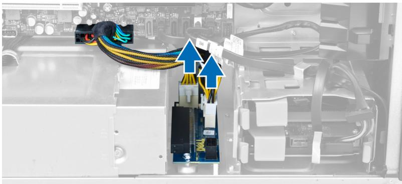
6. Remova os parafusos que prendem a placa de PSU ao encaixe.
